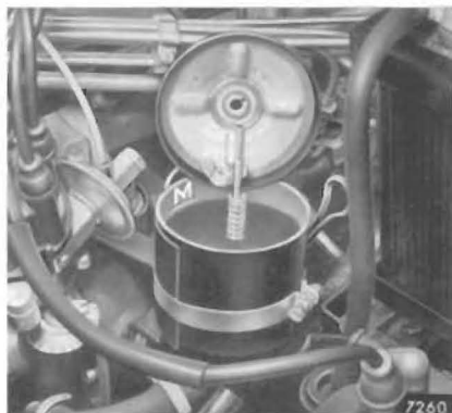
Behälter der Druckölpumpe M Ölstandmarke
