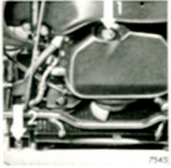
Motor-Ölablaß- schraube Ölkühler-Ablasschraube
