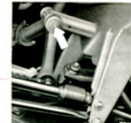
Lager des Lenkungs- zwischenhebels (1) (sofern nicht wartungsfrei)
