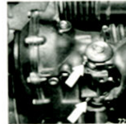
Schmiernippel an der Hinterachse (2)
