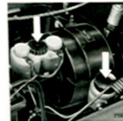
Vorratsbehälter für Bremse und Kupplung
