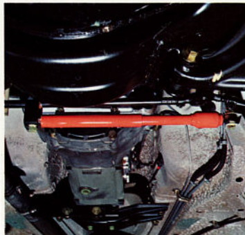
Feinheiten in der technischen Ausstattung: Alle Mercedes-Benz Personenwagen haben einen hydraulischen Lenkungsstoßdämpfer.
