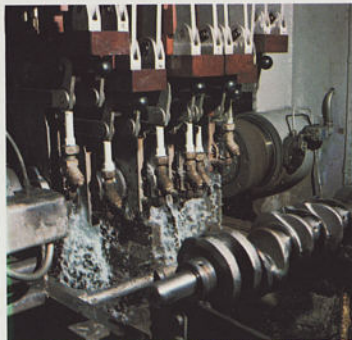
Induktive Kurbelwellenhärtung bedeutet: genau gesteuerte Veredelung der wichtigen Stellen. Nichts bleibt dem Zufall überlassen.
