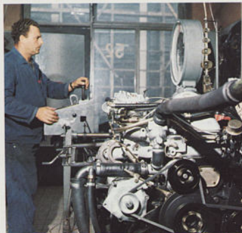
Jeder Motor kommt auf den Prüfstand zum Spüllauf mit permanentem Ölaustausch und Bremslauf. Stichproben genügen nicht.
