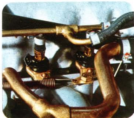
Zwei der acht Einspritzelemente des V8-Motors.
