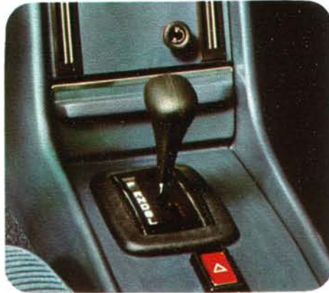
Der 450 SLC ist serienmäßig mit der 3-Gang-Wandler-Automatic und Mittelwählhebel ausgerüstet.
