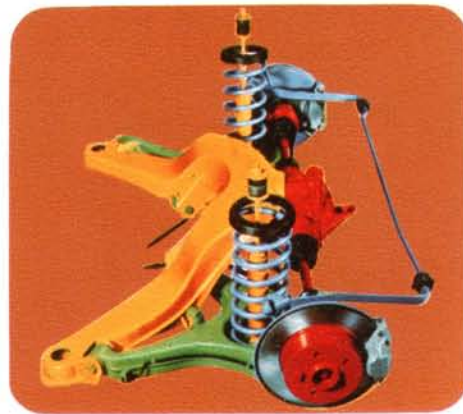
Die Mercedes-Benz Diagonal-Pendelachse sorgt für sichere Bodenhaftung der Antriebsräder unter allen Bedingungen.
