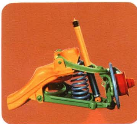
■ Einzelradführung und -federung; vorn: Doppelquerlenker mit Bremsnick-Abstützung.
