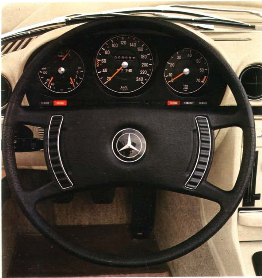
Das Vierspeichen-Sicherheitslenkrad. Nabe, Polsterplatte, Speichen und Kranz sind eine mit Kunststoff umschäumte Einheit.
