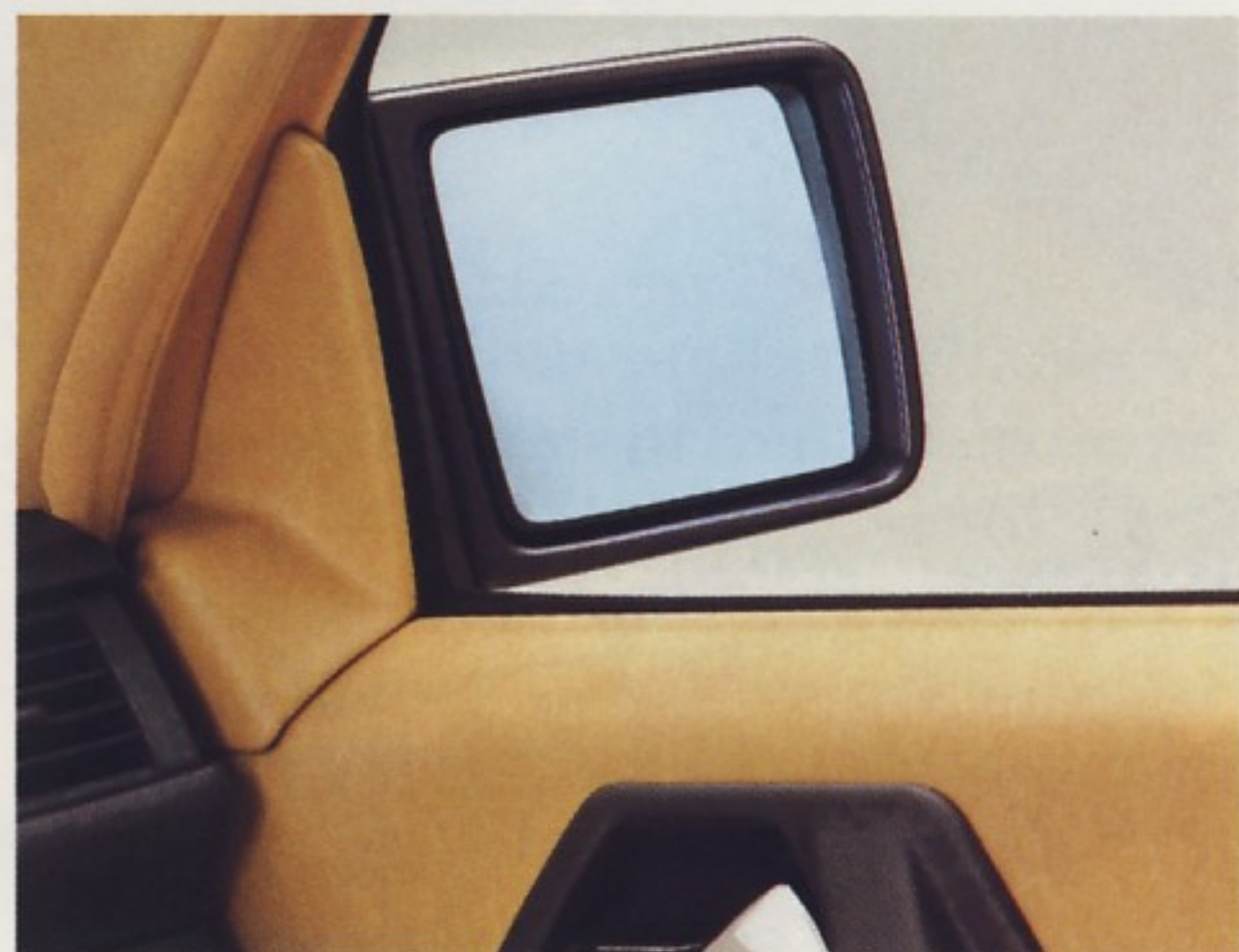
Rechter Außenspiegel beheizt, von innen elektrisch einstellbar.
