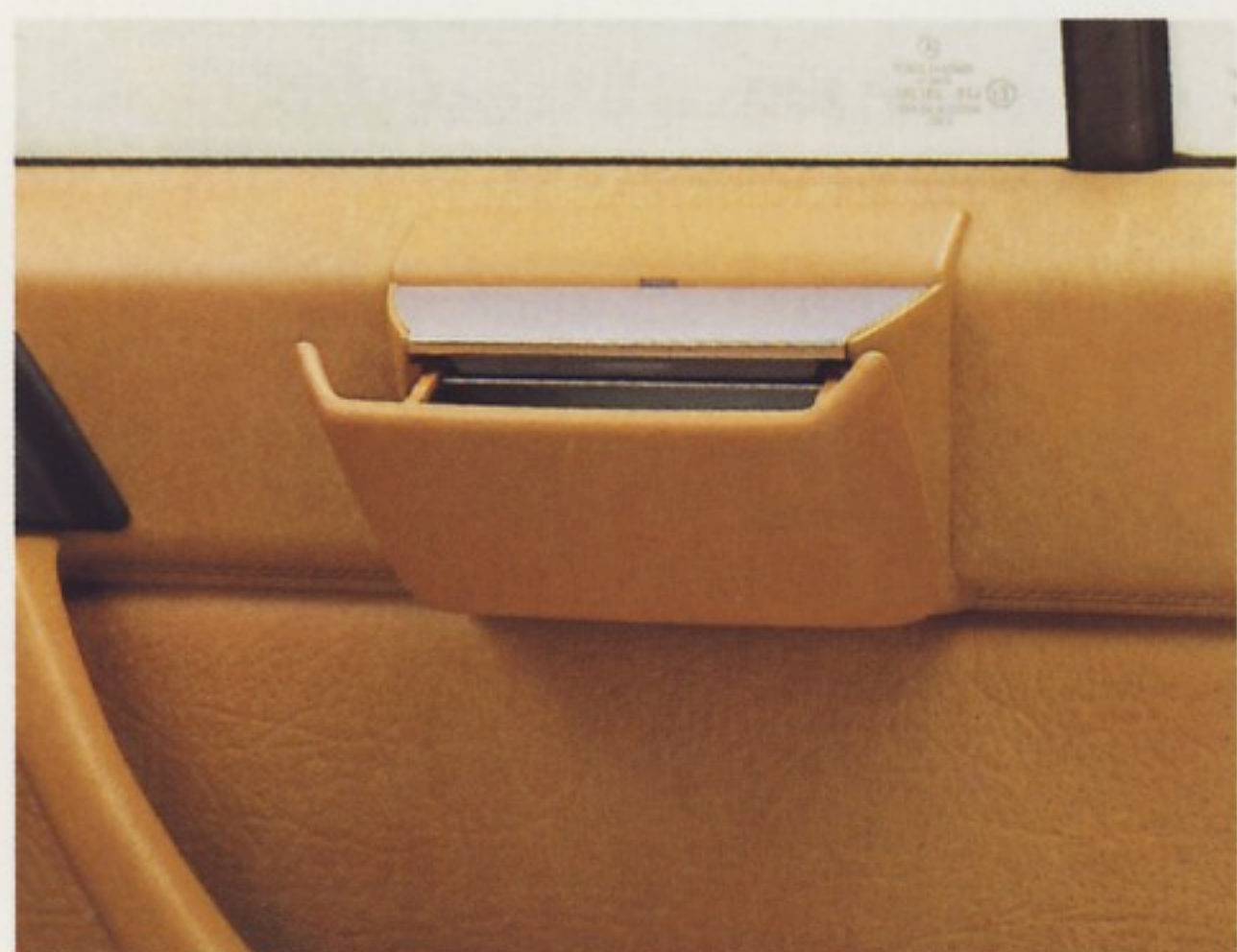
Aschenbecher in den Fondtüren, gegen Herausreißen gesichert.
