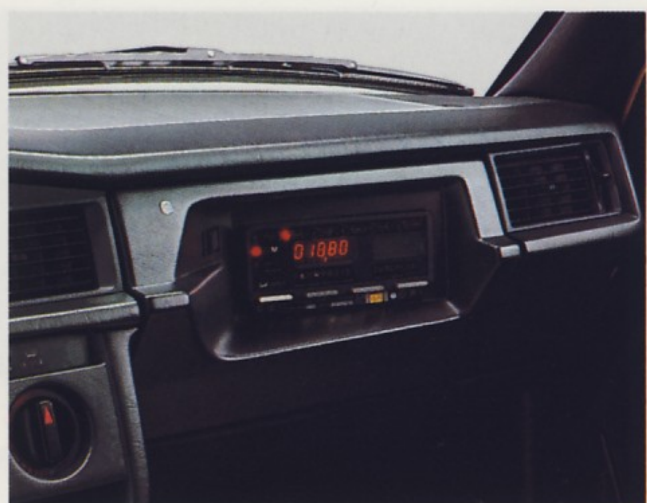
Handschuhkasten vorbereitet zum Einbau elektronischer Taxameter (190 D – 190 E 2.3).
