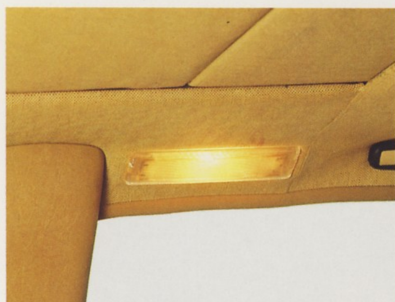
Dreifache, in der Helligkeit verstärkte Fond-Innenraum-Beleuchtung für die Modelle 200 D–230 E.
