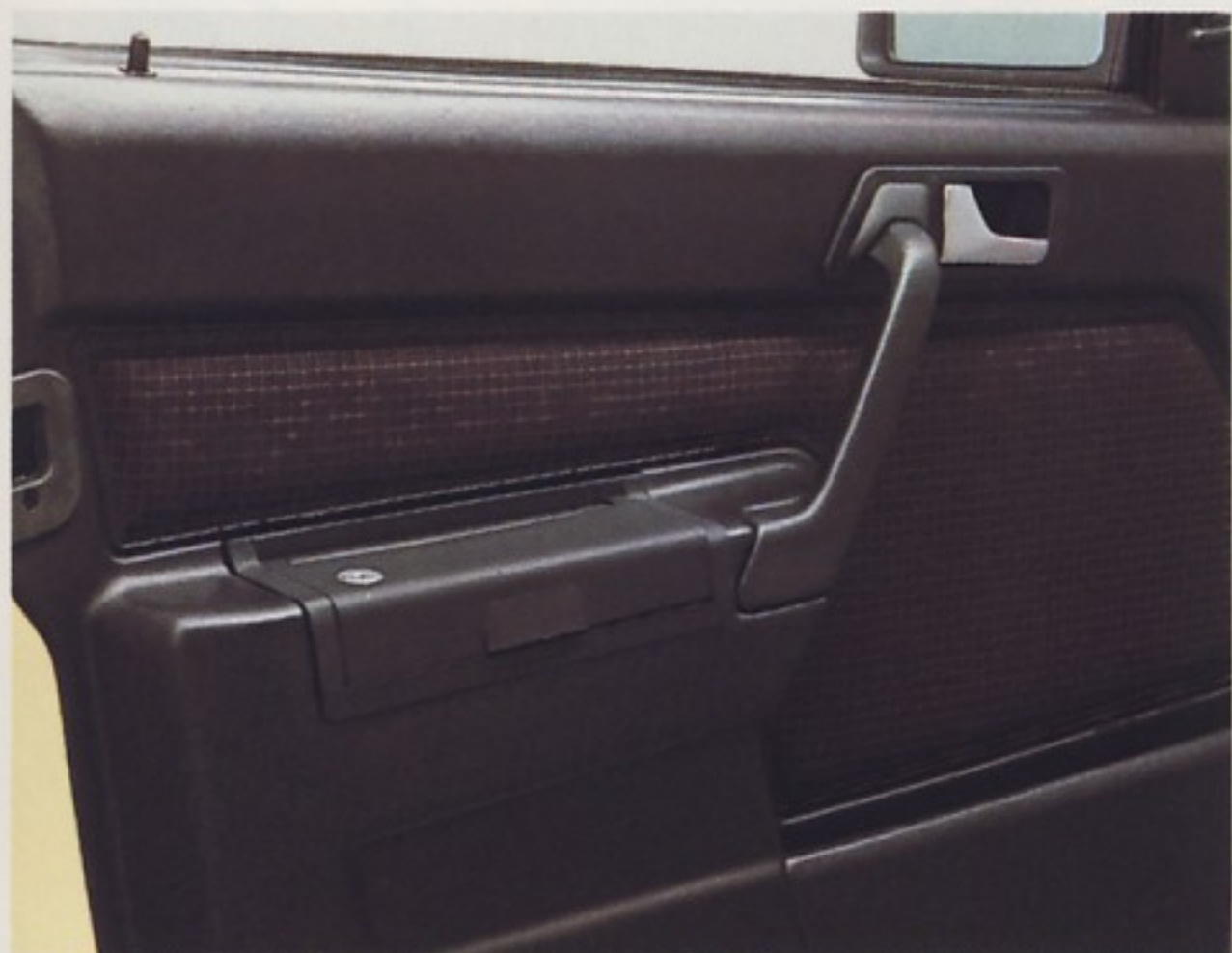
Verschlüsselter Behälter in Fahrertür (190 D – 190 E 2.3).
