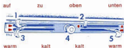
Regulierung der Lüftung und Heizung
