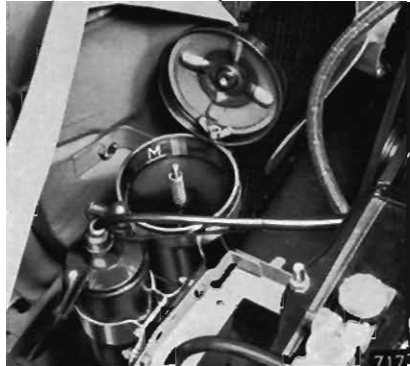
Behälter der Druckölpumpe M Ölstandmarke
