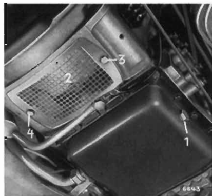
1 Getriebe-Ölablaßschraube 2 Kupplungsgehäusedeckel 3 Befestigungsschrauben 4
