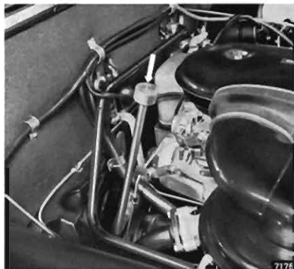
Autom. DB-Getriebe: Ölmeßstab
